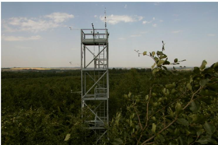
**Figure 14** : Photo d'une tour permettant la mesure des flux de  $\text{CO}_2$  et  $\text{H}_2\text{O}$
