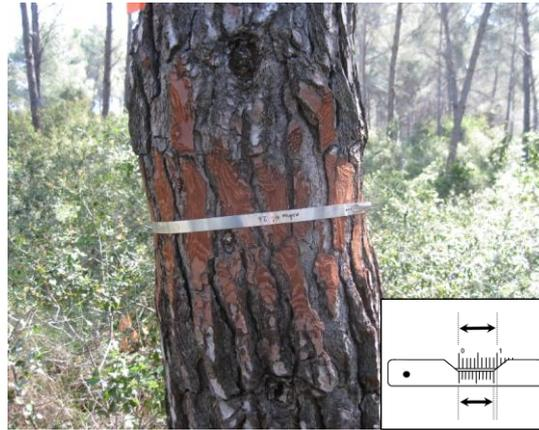
Fig. 15: Dendromicromètre manuel sur un pin d'Alep à Gémenos et son vernier pour la lecture de la valeur d'accroissement en circonférence
