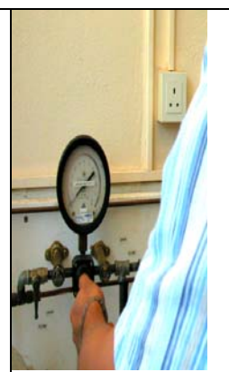
Photo n°7 : ouverture du robinet à pression
