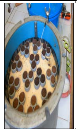
Photo n° 4 : Mise de la plaque dans la chambre
