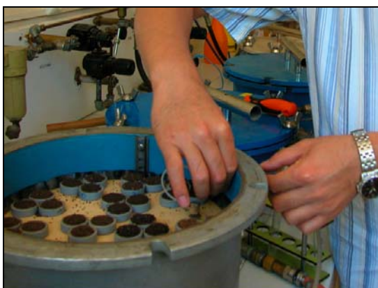
Photo n°5 : Connexion du capillaire pour l'évacuation de l'eau
