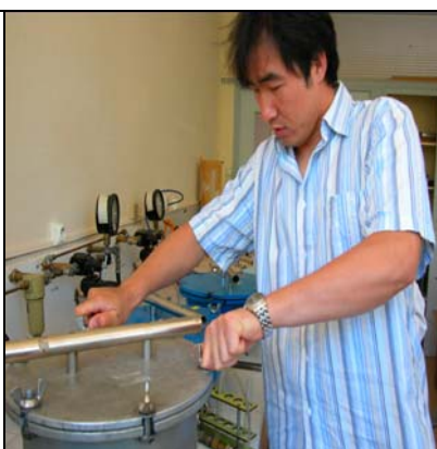
Photo n°6 : Fermeture de la chambre avec les boulons
