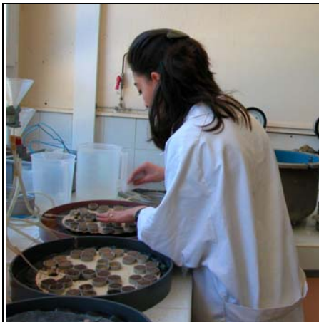
Photo n° 3 : Mise des échantillons sur les plaques saturées.
